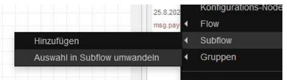
Die Nodes *funktion* und *delay* werden mit der Maus markiert. Im Menü *Subflow/ Auswahl in Subflow umwandeln* anklicken.
