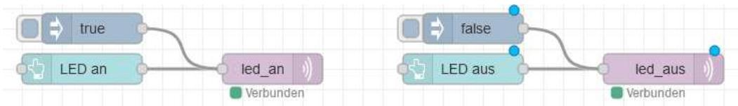
Im Beispiel wird über MQTT eine LED am Fischertechnik TXT 4.0 über einen Button oder über die injekt-Node ein bzw. ausgeschaltet. Das Ergebnis ist nun nur am TXT sichtbar.
