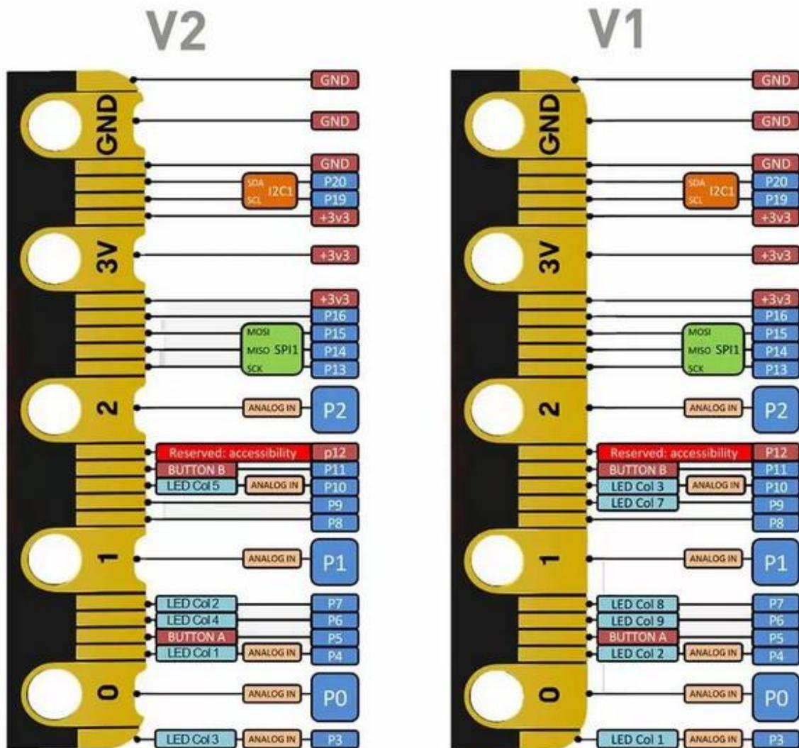
Im Gegensatz zu den drei großen Pins, die für externe Verbindungen bestimmt sind, werden einige der kleinen Pins mit anderen Komponenten auf der micro:bit-Platine geteilt. Pin 3 wird beispielsweise mit einigen der LEDs auf dem Bildschirm des micro:bit geteilt. Wenn Sie also den Bildschirm zum Scrollen von Nachrichten verwenden, können Sie diesen Pin nicht ebenfalls verwenden.
