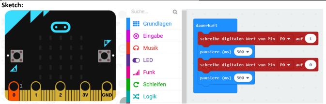
In der Dauerschleife wird die LED abwechselnd ein- und ausgeschaltet. Dazwischen wartet das Programm jedes Mal 500 Millisekunden lang.
