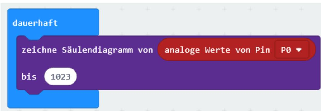
Dieser Block stellt den analogen Wert als Balkengrafik auf der LED-Matrix dar. Der zweite Wert in diesem Block gibt den maximal möglichen Wert der Balkengrafik an, um die Werte auf die LED-Matrix zu skalieren. 20% des maximal möglichen Wertes entspricht also einer Zeile von LEDs. Zwischenwerte werden dargestellt, indem die nächsthöhere Zeile in der Mitte beginnend aufgefüllt wird.
