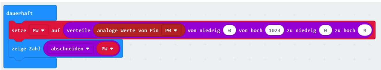
Der Wert wird in einer Variablen (PW) übergeben. Dabei wird mit dem Block „Verteile“ der Wert zwischen Min. und max. heruntergerechnet auf einen Wert zwischen 0 und 9. Zur besseren Darstellung, ohne Scrollen, wird dann dem Wert um die Kommastelle beschnitten.
