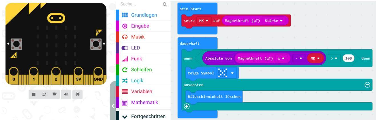
Im Startblock wird die Intensität des Magnetfeldes in der Nähe des micro:bit gemessen um die Magnetkraft ohne Dauermagnet zu bestimmen. In der Schleife wird gemessen, ob der absolute Wert (Wert bei dem das Vorzeichen entfernt wird) der Differenz zwischen dem Aktuell gemessenem und dem Startwert über 100 liegt. Dann wird das „X“ ausgegeben.
