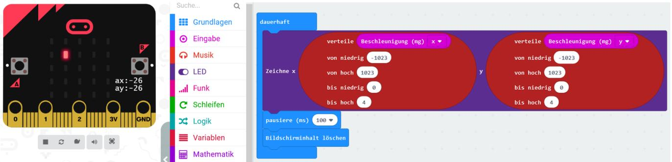
Beispiel Wasserwaage. Die Beschleunigungswerte von x und y (-1023 bis 1023) werden auf Werte zwischen 0 bis 4 heruntergerechnet. Liegt der micro:bit gerade auf dem Tisch, sollte die mittlere LED leuchten. Dieses Programm kann auch Grundlage für Geschicklichkeitsspiele sein.
