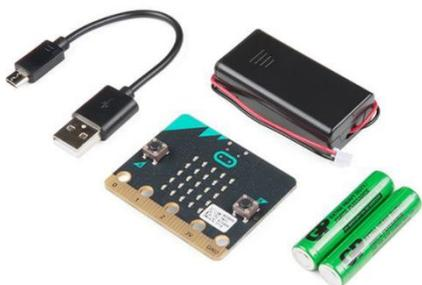
Über ein Micro USB Kabel (+5V) zum Anschluss des BBC micro:bit an einem Computer. Das ist das gleiche Kabel wie bei den meisten Smartphone. Wenn der BBC micro:bit nicht mit dem Computer verbunden ist, benötigt man 2x AAA Batterien für die Spannungsversorgung (+3V). Beide Spannungsversorgungen können gleichzeitig angesteckt sein. Der BBC micro:bit schaltet automatisch auf USB Versorgung um, wenn ein Computer angeschlossen wird.
